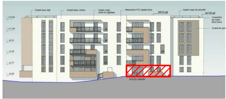
PC5.2 Elévation NORD-OUEST bât.B Ech: 1 : 250
