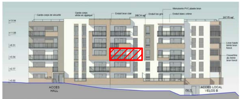
PC5.2 Elévation SUD-EST bât.B Ech: 1 : 250
