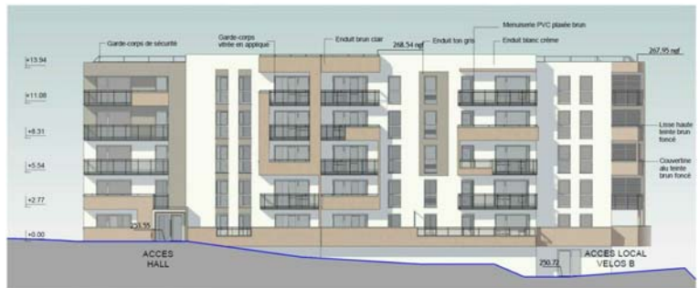
PC5.2 Elévation SUD-EST bât.B Ech: 1 : 250
