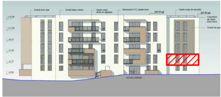
PC5.2 Elévation NORD-OUEST bât.B Ech: 1 : 250
