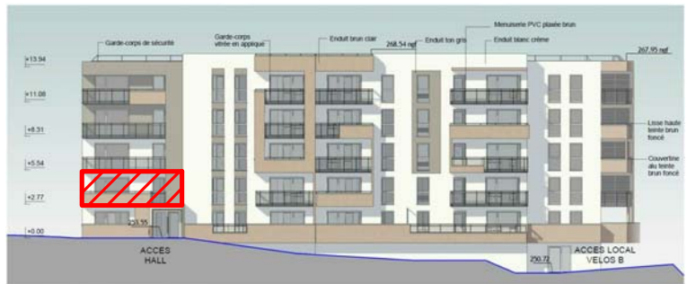
PC5.2 Elévation SUD-EST bât.B Ech: 1 : 250
