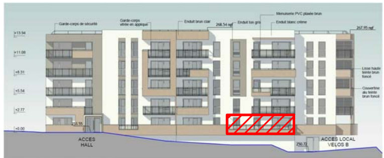
PC5.2 Elévation SUD-EST bât.B Ech: 1 : 250
