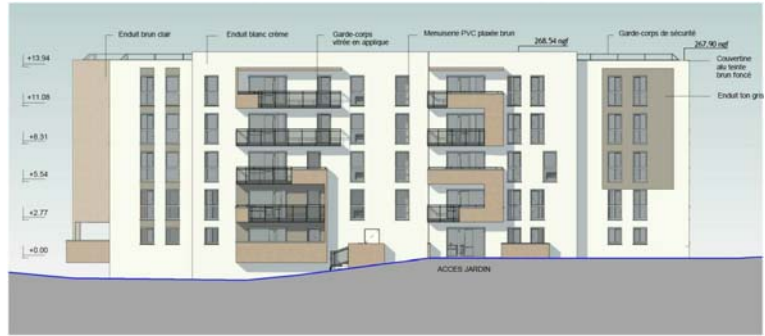
PC5.2 Elévation NORD-OUEST bât.B Ech: 1 : 250
