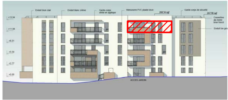
PC5.2 Elévation NORD-OUEST bât.B Ech: 1 : 250
