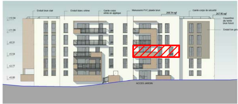
PC5.2 Elévation NORD-OUEST bât.B Ech: 1 : 250
