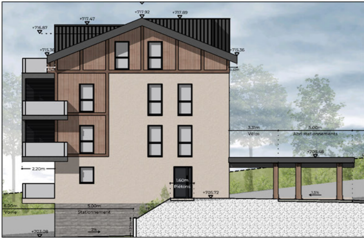
BÂTIMENT A - FAÇADE EST
